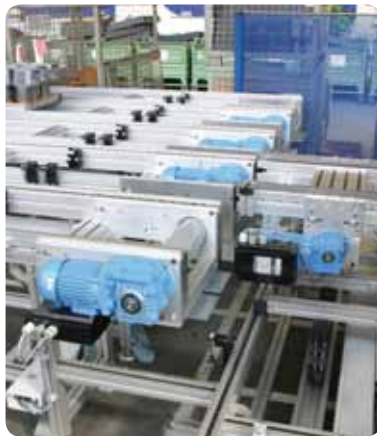
Obr. 1 Od roku 2017 musí být tato zařízení, pokud podléhají požadavkům MEPS, vybavena motory IE3 nebo kombinací motoru IE2 s měničem kmitočtu. Tímto opatřením dojde k energetické optimalizaci zařízení
